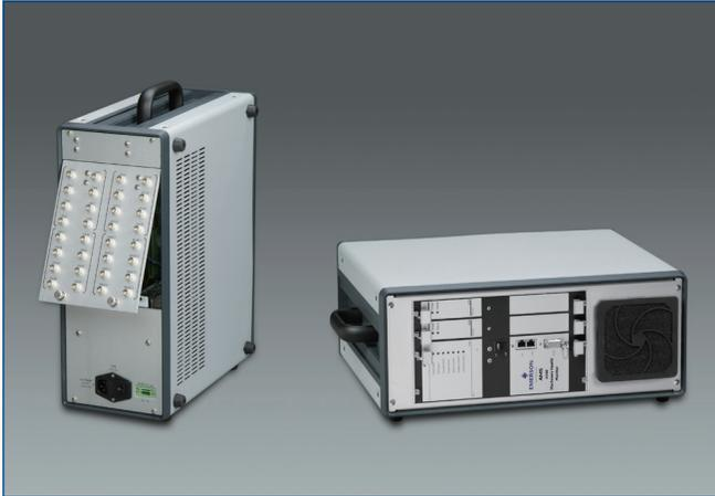
AMS 2600 设计成既可直立放置，用于在狭窄的空间使用，也可以把它放平，顶部用来放置笔记本电脑。接线面板采用铰链式设计，可以打开后直接与面板端子相连，从而提供了多种传感器的接线方式。
